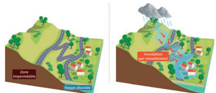
Fig. 5 et 6. Inondation par ruissellement
