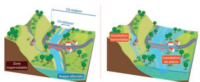
Fig. 3 et 4. Inondation par débordement de cours d'eau
